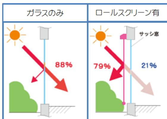
左の図のように、ロールスクリーン有とガラスのみでは圧倒的に日射侵入率に差があります。日射しが室内に侵入しない分だけ冷房効率は上がり、エアコンの設定も下げなくても快適な室温を保つことが可能です。
